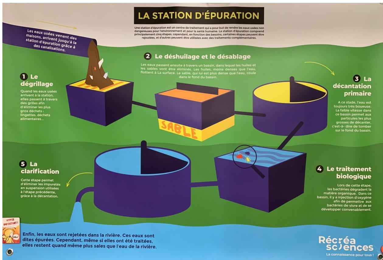
Comme une station d'épuration, nous allons suivre les différentes étapes et rendre l'eau plus pure.
